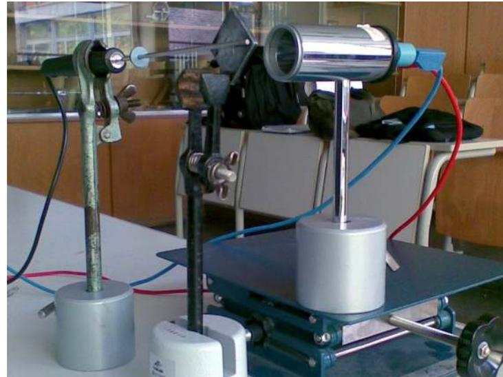
Messung von Temperatur und Strahlungsleistung (Thermosäule) mittels CASSY-Lab
