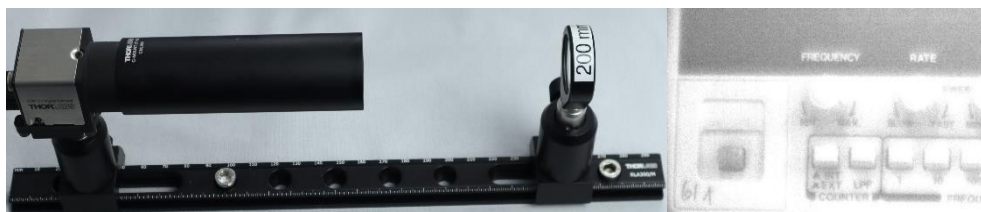
Abbildung 13: links: Kamera und Linse auf einer Schiene; rechts: scharfes Bild eines ca. 5 m entfernten Oszilloskops
