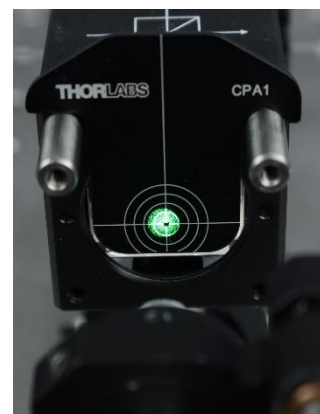
Abbildung 6: Höhenkalibrierung des Strahlteilers mithilfe des Justiertools
