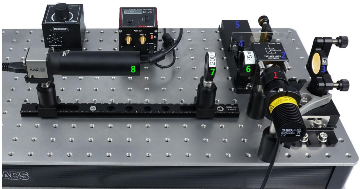
Abbildung 1: Fertiger Aufbau des optischen Kohärenztomographen
