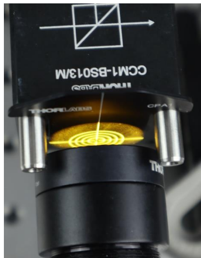
Abbildung 11: Ausrichtung der LED mithilfe des Justiertools
