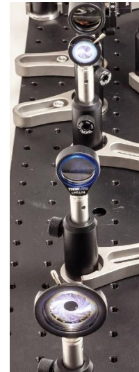
Abbildung 15: Positionierung der Feldlinse und Feld-Iris.
