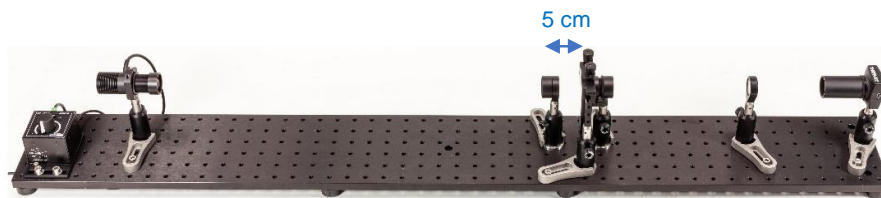
Abbildung 10: Positionierung der Kondensorlinse.
