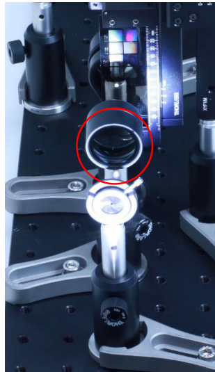
Abbildung 14: Die Apertur-Iris beschattet den Linsenhalter und die Kondensorlinse.
