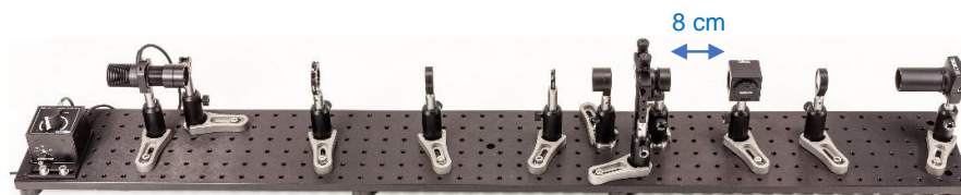
Abbildung 19: Positionierung des Strahlteilers
