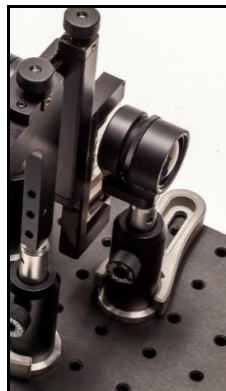
Abbildung 8: Position des XY-Halters mit dem Target
